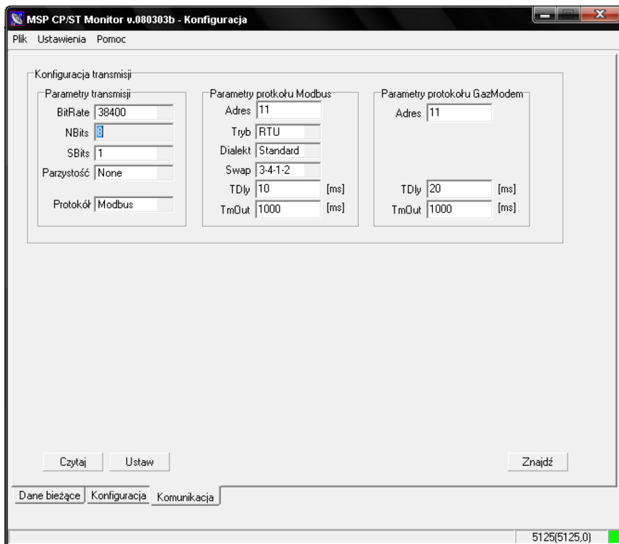
Rys. 13 Zakładka konfiguracji transmisji MSP-CP/ST MONITOR
